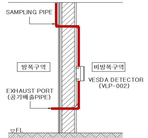
**Detector : AIR SAMPLING SMOKE DETECTOR**
